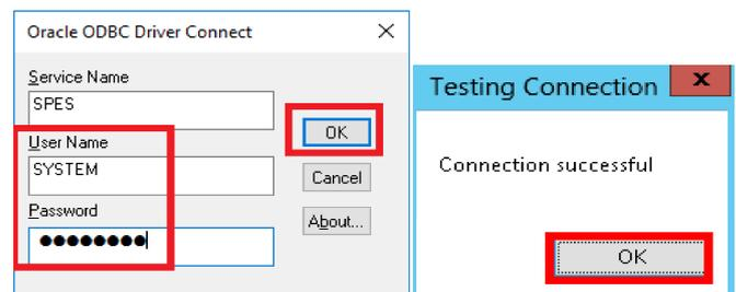
Em seguida, crie uma nova ODBC idêntica à anterior, mas com o nome de SMI\_RPT. Esta ODBC será usada pelos relatórios Crystal Reports no caso Oracle. O SQL Server não necessita desta segunda ODBC.
